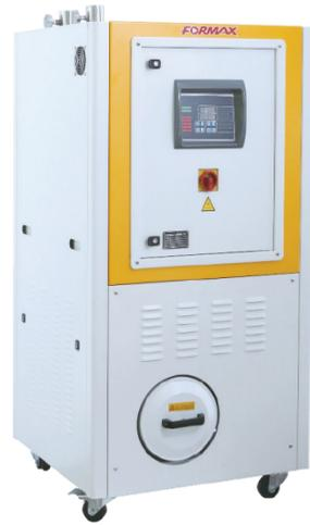
采用了「蜂巢式转轮」原理设计，可在露点为 -40℃ 的封闭式循环系统中连续运行，其特殊性的结构和陶瓷材料抗热绝缘性的特点分隔成：除湿干燥区、再生区、冷却区。
