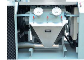
带有“V”形转子设计的破碎室确保操作安全可靠，并适合于各种破碎材料，即使是体积较大的材料也不例外。无论是破碎注塑件、浇口、型材、片材或薄膜，FC 系列机型都能破碎出高质量的均匀颗粒。
